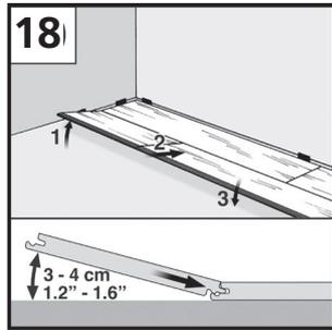
Poser le morceau de panneau de la deuxième rangée de façon que les côtés longitudinaux de panneau des 1e et 2e rangées posent parallèlement l'un à côté de l'autre et ne soient pas encliquetés [16]. C'est-à-dire le côté languette de la 2e rangée pose sur le côté rainure de la 1e rangée. Avant d'encliqueter, poser d'autres panneaux jusqu'à la fin de la 2e rangée. Procéder comme pour la 1e rangée [17].
