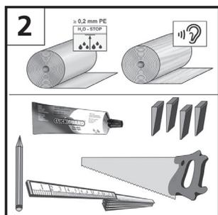
**Préparation:** Stocker les paquets 48 heures avant la pose dans les mêmes conditions climatiques qu'à la pose [1]. La condition importante pour l'installation et une longue durée de vie du sol stratifié est un climat intérieur d'env. 20°C et une humidité relative de l'air de 50 - 70 %.
