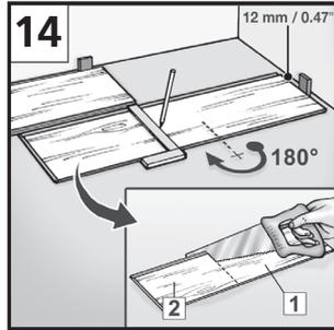
La pose commence dans le coin gauche de la pièce. Poser le premier panneau avec le côté languette vers le mur et avec des cales d'écartement, assurer impérativement la distance de bord. Respecter impérativement une distance de 12-15 mm (joint de dilatation) par rapport au mur, à la tuyauterie de chauffage, aux piliers, aux bloqueurs de porte etc. [12].
